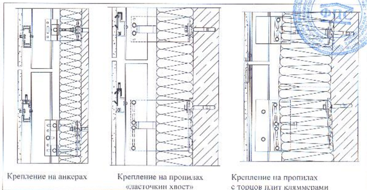
Рис.4. Скрытый способ крепления
