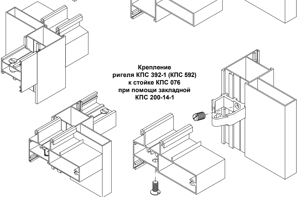
Усиленное крепление ригеля КПС 392-1 при помощи закладной КПС 200-14-1 и винта 4,8x32 DIN 7981
