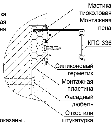
Вариант монтажа двери с помощью монтажных пластин
